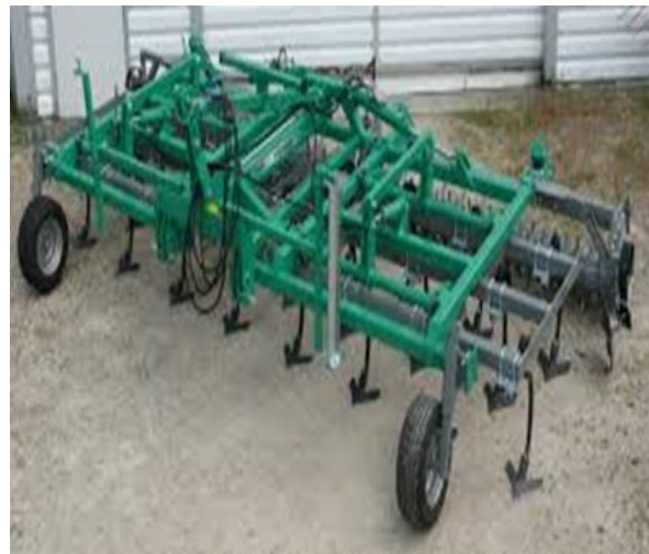
Рис. 5.6. Культиватор для міжрядного обробітку ґрунту КПС-4
