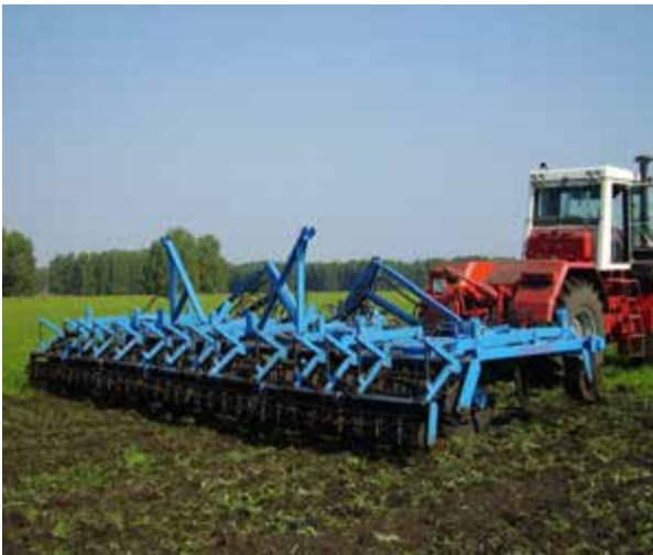
Рис. 5.6. Культиватор для міжрядного обробітку ґрунту КПС-4
