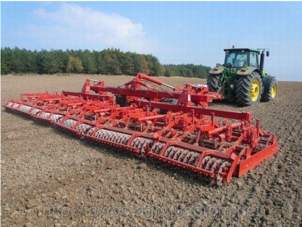
Рис. 5.10 Робота агрегату з кільчасто-шпоровим котком типу ККШ.
