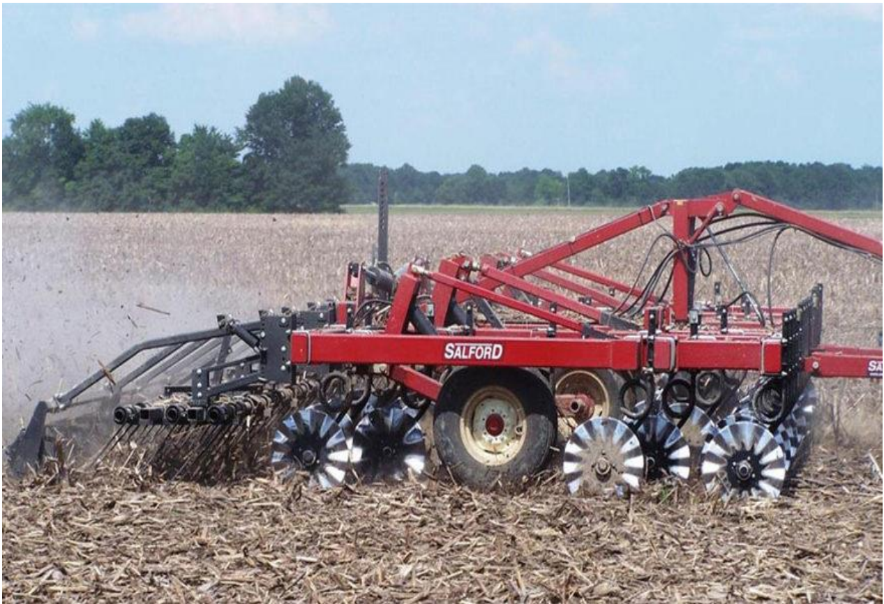
Рис 5.9. Знаряддя для вертикального обробітку ґрунту Salford RTS I-2100
