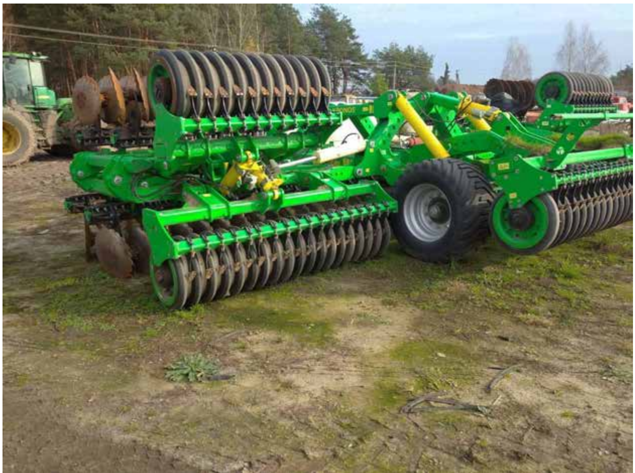
Рис.5.12 Сучасні дискові знаряддя для обробітку ґрунту
