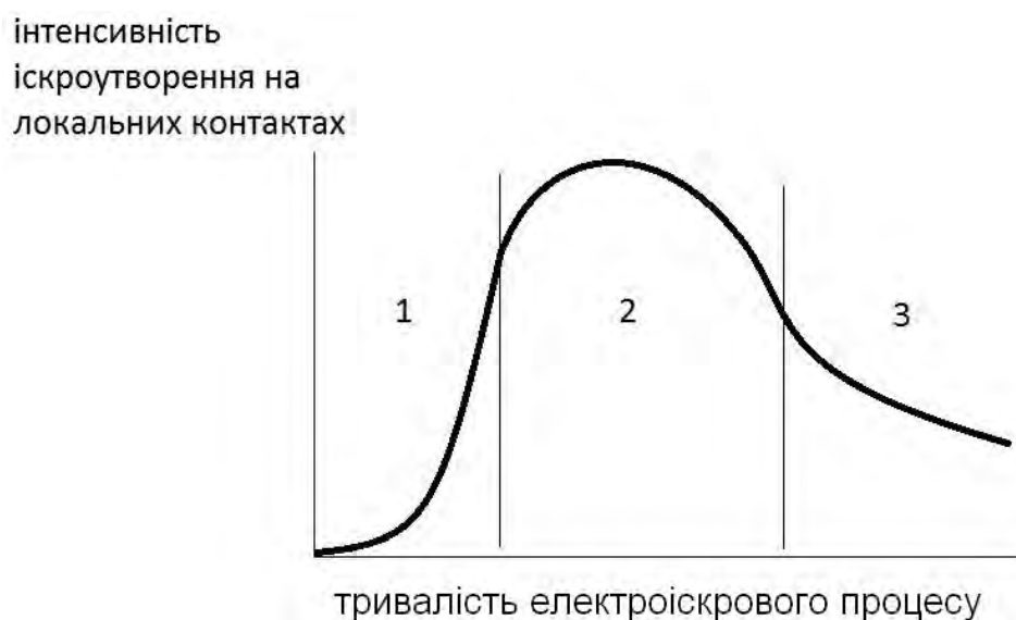
Рис. 5.10. Зміна характеру іскроутворення на протязі електроіскрового процесу
