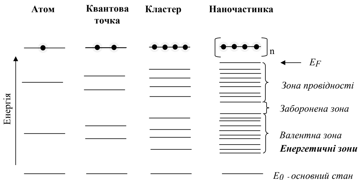
Рис. 5.2. Зміна (розщеплення) енергетичних рівнів при зміні будови нанооб'єкту: а – атому; б – квантової точки; в – кластеру; г – наночастинки
