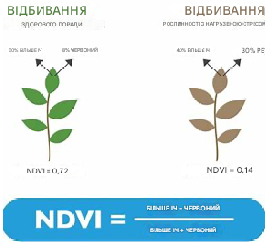
Рис.2.5: Прояв рівня NDVI — нормалізований різницевий вегетаційний індекс в цифрових показниках. Джерело: https://tse2.mm.bing.net/th/id/OIP.Tba-9HQJxmyt2R00bxidhQHaGK?w=474&h=474&c=7&p=0
